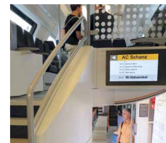
VisiWeb neo in laufendem Betrieb im Fahrgastraum des RRR: gut sichtbarer TFT-Monitor mit Streckenverlauf.
